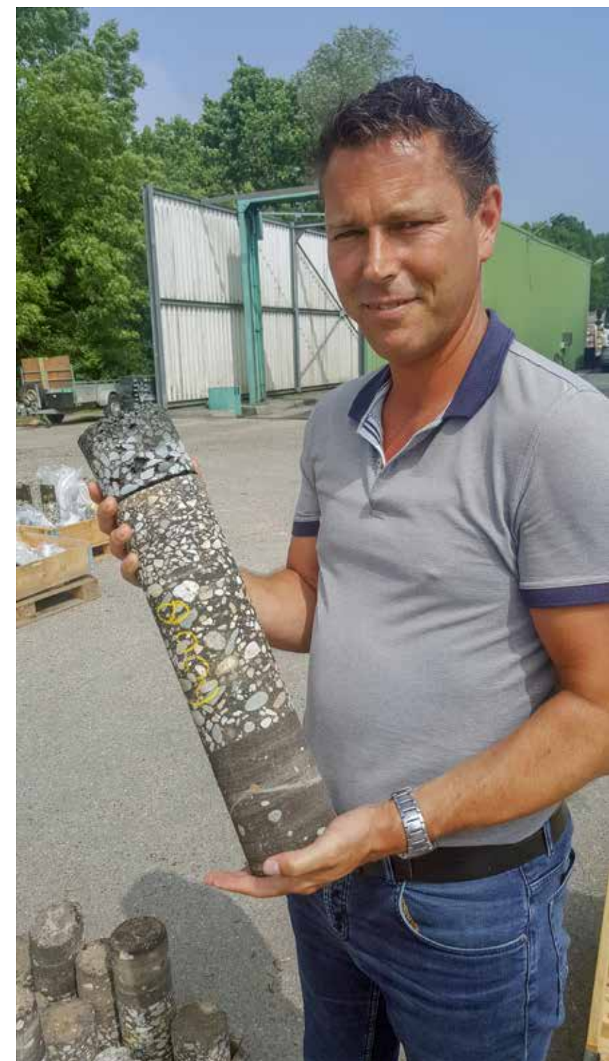
Jeroen Bleeker toont een boorkern proefstuk. Duidelijk zichtbaar: de diverse verhardingslagen onder het wegdek, in dit geval de A27.
